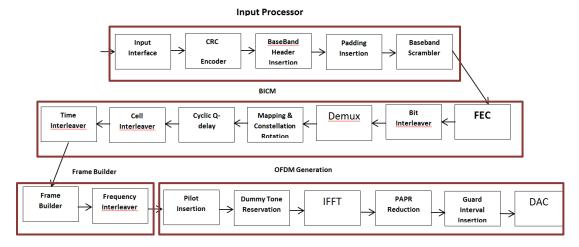
Fig. 3.2: DVB-T2 Block diagram
