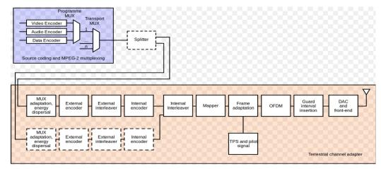
Fig. 2.11: DVB-T Block Diagram [28]
